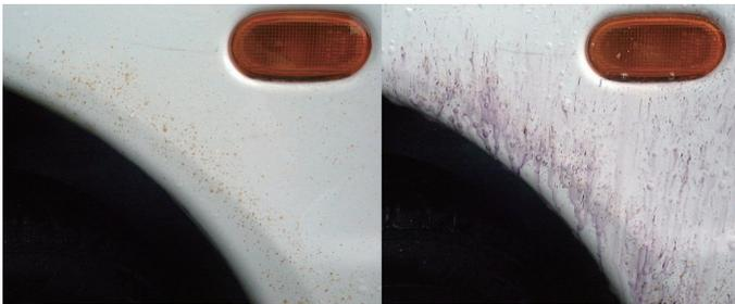
写真左では、ボデーに茶色の斑点(錆)がついています。薬剤を塗布する(写真右)と斑点のなかった部分も反応しています。錆の予備軍「鉄粉」は目に見えませんが、普通の洗車では落ちません。放置すると大変。補修には塗装が必要です。(通常、車検・法定点検時に鉄粉除去1回処理)
